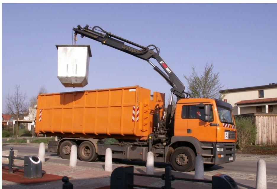
*Beispiel für die Leerung eines Unterflurbehälters*
