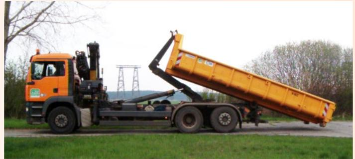
Abrollcontainerfahrzeuge benutzen zum Absetzen des Containers einen hydraulisch betriebenen Haken. Dieser hebt den Container an und **rollt** diesen über zwei 300 mm breite Stahlrollen, die sich am hinteren Ende des Containers befinden, am Aufstellort ab.
