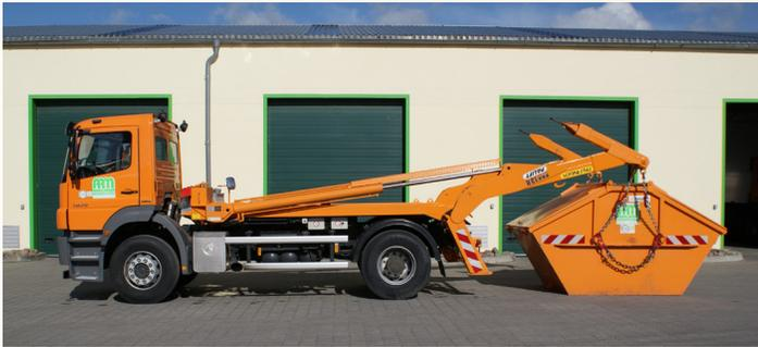
Absetzkipperfahrzeuge **setzen** die Container mittels Ketten, die an zwei hydraulischen, nach hinten klappbaren und ausfahrbaren Schwenkarmen befestigt sind, am Aufstellort ab.
